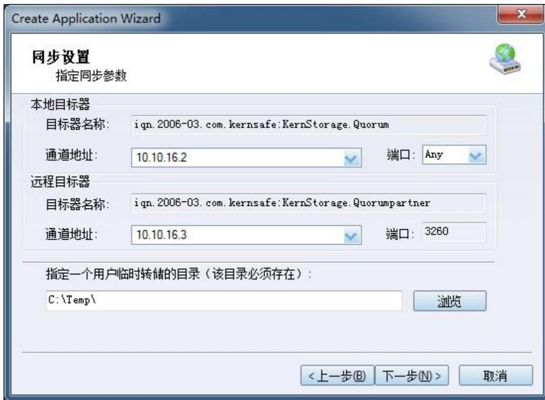
通道端口选择同步端口，也称作心跳网。
