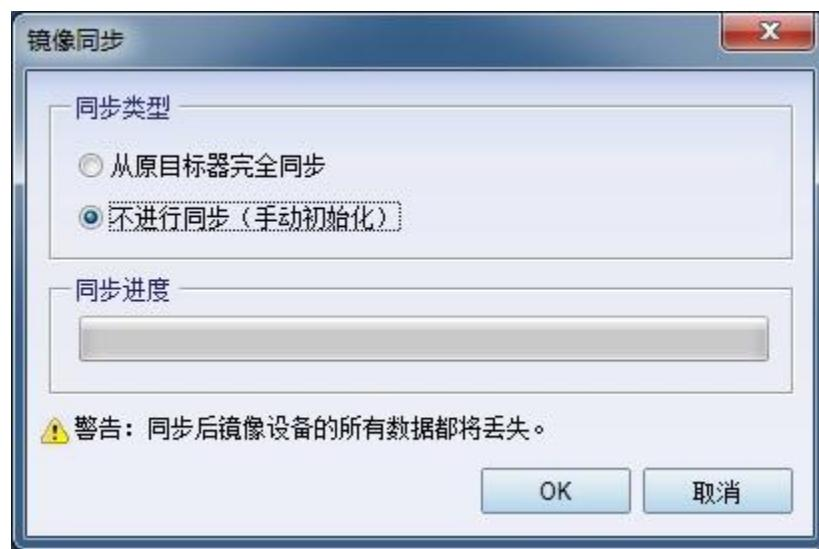
现在镜像目标器应同步到源目标器，如果这两个目标器都是新目标器，没有被初始化，我们可以选择“不同步创建镜像设备（手动初始化） **Create mirror device without synchronization (Manual**
