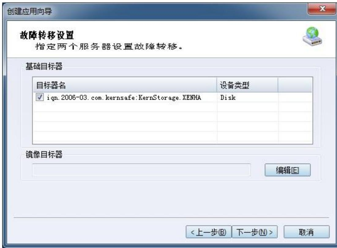
选择 **KernSafe.XenTarget1** 存储，并点击“编辑 (Edit)”找到镜像目标器。
