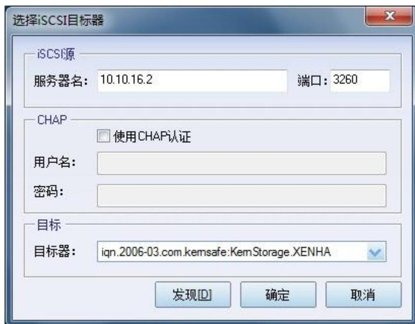
在“iSCSI 源 (iSCSI Source)”选项卡上输入服务器 1 的 IP 地址和端口，然后单击窗口底部的“发现 (Discovery)”找到镜像目标器，在下拉列表中选择 **KernSafe.XenTarget1**。
