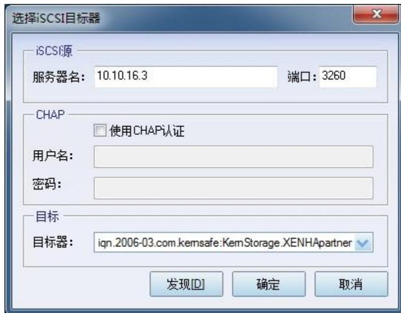
在“iSCSI 源（iSCSI Source）”选项卡上输入服务器 2 的 IP 地址和端口，然后单击窗口底部的“发现（Discovery）”找到镜像目标器，在下拉列表中选择 **KernSafe.XenTarget2**。
