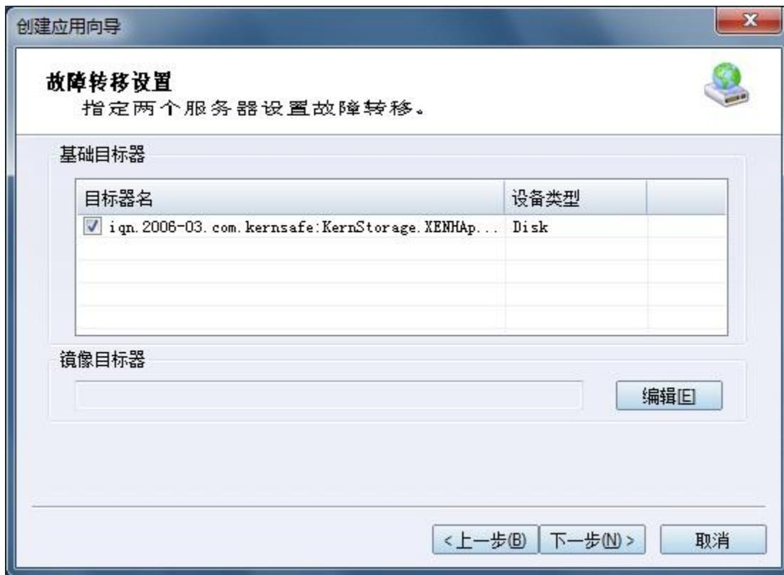
选择 **KernSafe.XenTarget2** 存储，并点击“编辑 (Edit)”找到镜像目标器。
